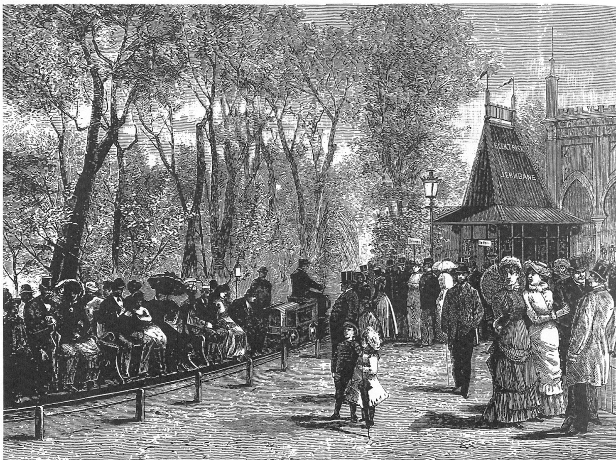
I Tivoli sørgede direktør Bernhard Olsen for, at gæsterne i 1882 fik smag for den lydsvage elektriske transport. Den anlagte bane var den, som Siemens & Halske havde imponeret udstillingsgæsterne med i Berlin i 1879. Strømmen til motorvognens elektromotor førtes frem via skinnerne. En 12 HK Otto gasmaskine og en Siemens dynamo sørgede for strømforsyningen. Men politiet havde sat en grænse for, hvor hurtigt, der måtte køres. (Illustreret Tidende 1882)
