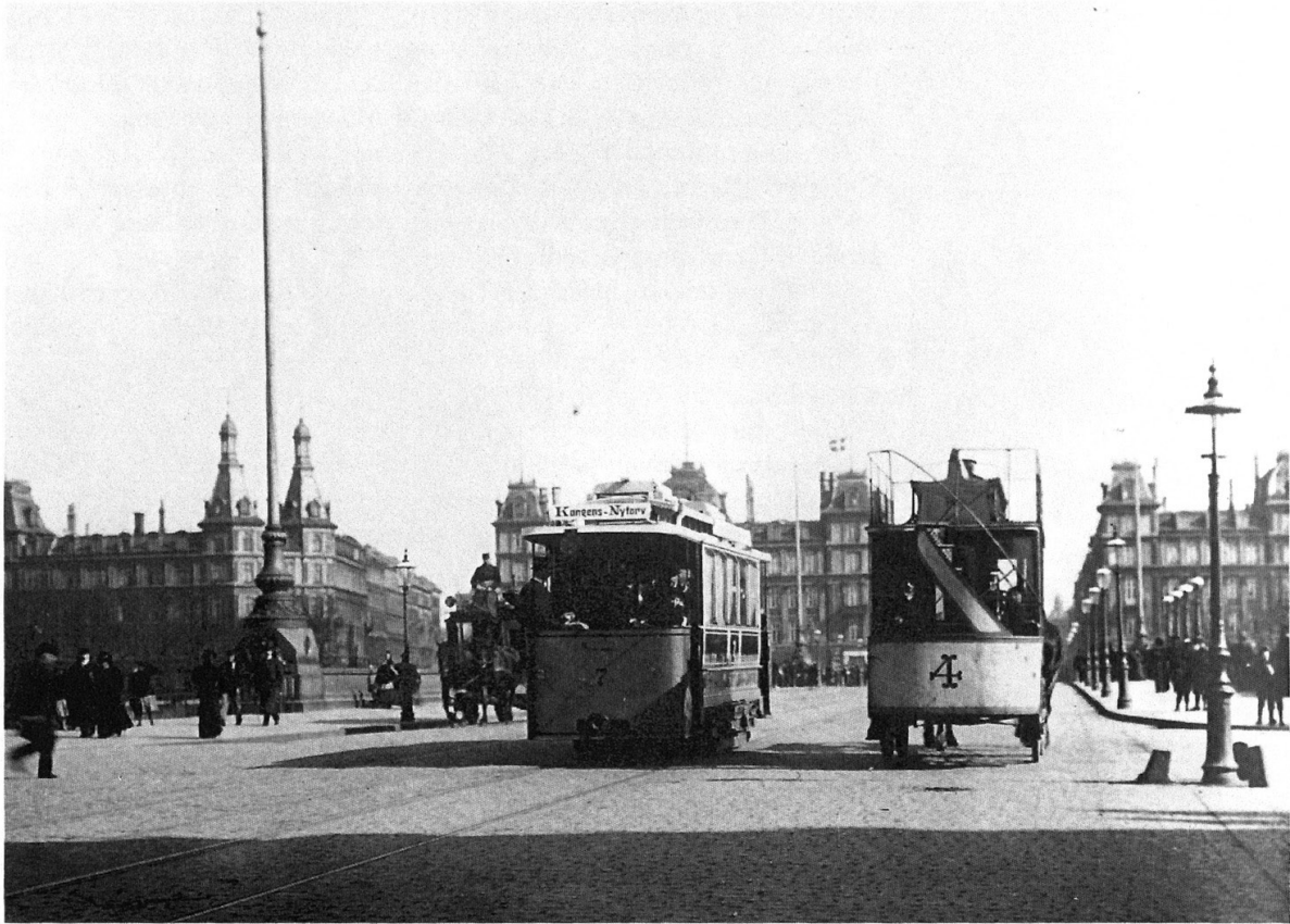
På Dr. Louises Bro i København mødes i 1897 gammelt og nyt: en "syrevogn" passerer den hestetrukne på sin vej ud mod de nye kvarterer på Nørrebro. P. Elfelt har fotograferet.
